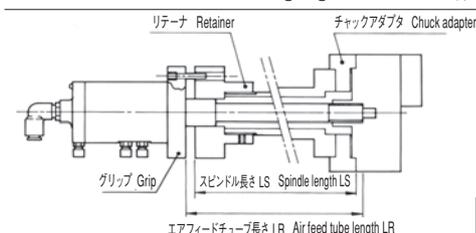
エアフィードチューブ(クーラントタイプ、ノンクーラントタイプ)をご注文頂きます場合は、図示の如くスピンドル長さLS又はエアフィードチューブ長さLRをご指示下さい。LSに対するLRは、LR=LS+17となります。(KPC43C048のみLR=LS+12)
