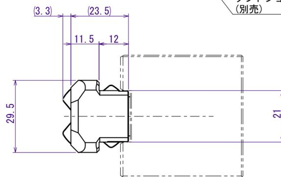
BR-AJC\*\*Mはパワーチャックのソフトジョー取付用で、下記のチャックでのみ使用できます。BR-AJC\*\*Mを使用して成形したソフトジョーは、チャックから一度取り外した場合でも、再度同じ場所に取り付け直すことで成形直後と同等の把握精度を維持できます。また、セレーションの山を数えることなくジョー交換が可能です。
